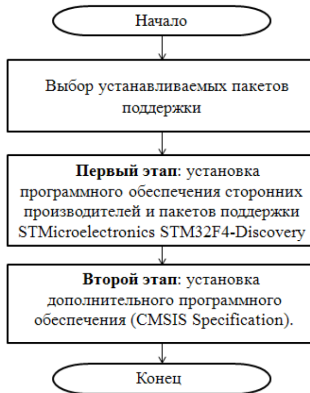
Рис. 10 – Алгоритм налаштування Matlab Simulink для програмування мікроконтролера STM32F4Discovery
